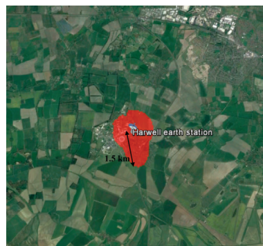
Gambar 14. Batas Area Interferensi dari 5G UE ke Stasiun Bumi EESS (ECC, 2017b)
